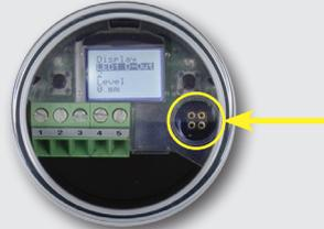
Connecteur pour adaptateur MPI-200-F comme connecteur intermédiaire entre l'électronique de la NSL-F et la prise 3 du MPI-200 (voir l'image suivante).
