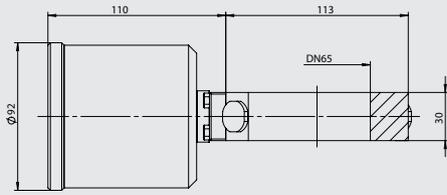
Bloc optique pour DN25 à DN40
