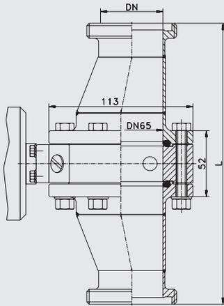
Raccord laitier DIN ITM-4DW/GG pour DN25 à DN40
