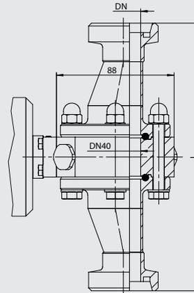
Tri-Clamp DIN ITM-4DW/TC pour DN50 à DN100
