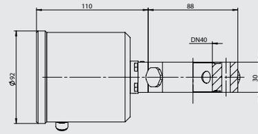
Raccord laitier DIN ITM-4DW/GG pour DN50 à DN100
