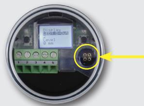
Connecteur pour adaptateur MPI-200-F comme connecteur intermédiaire entre l'électronique de l'ILM-4 et la prise 3 du MPI-200 (voir l'image suivante).
