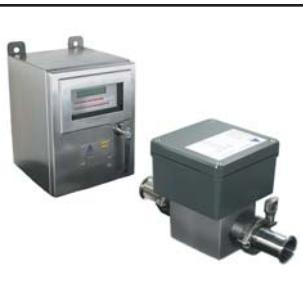
DS1：包含IZML流量计以及一个不锈钢外壳的FTT控制器/记录仪。可以测量牛奶流量、记录牛奶体积，可以连接外部输入进行远程归零（经常应用在批处理管理）。本系统也可用于牛奶装运过程中的溢出报警。标准的配置包括清洗过程中110VAC输入抑制测量，110VAC运行，包括流量计和控制器之间的接线。
